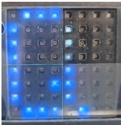
Fot. 3 Demonstrator wyświetlacza UV-microLED wykorzystującego niebieskie kropki kwantowe Emitenta (źródło: Spółka)
